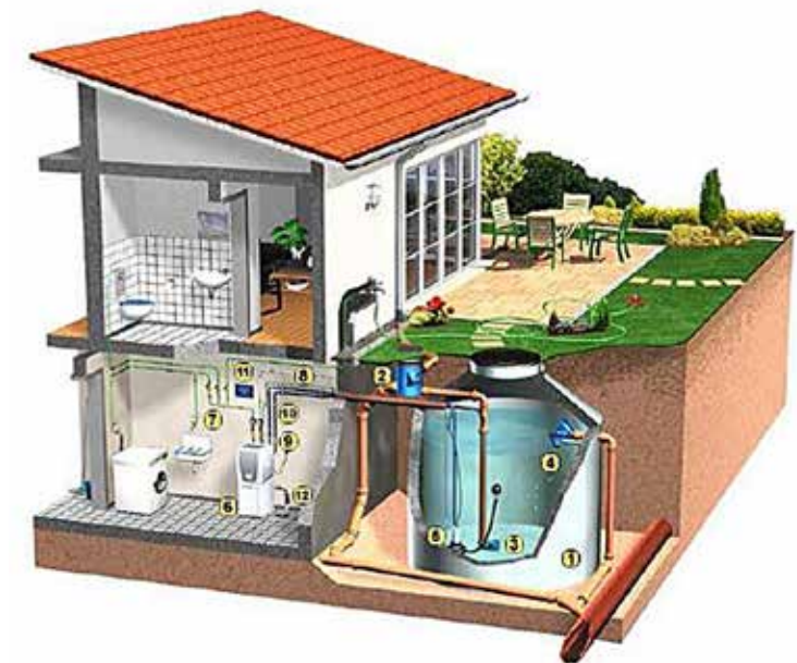
Esempio di recupero delle acque meteoriche dei tetti per usi interni all'abitazione, tramite l'utilizzo di un filtro [2] e di un serbatoio di stoccaggio [1] (Fonte: http://www.3ptechnik.de )
